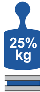
Horizontal montiert = 25% genannter Lastwert
